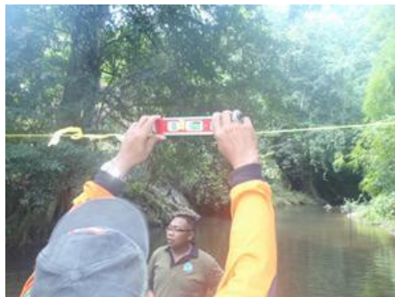
Gambar 40. Pengukuran penampang sungai menggunakan alat bantu waterpass di SPTN III Kalibaru, tanggal 3 – 7 Agustus 2015.
